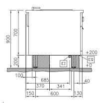
D Drain Electrical inlet (power) ΕI EQ Equipotential screw
